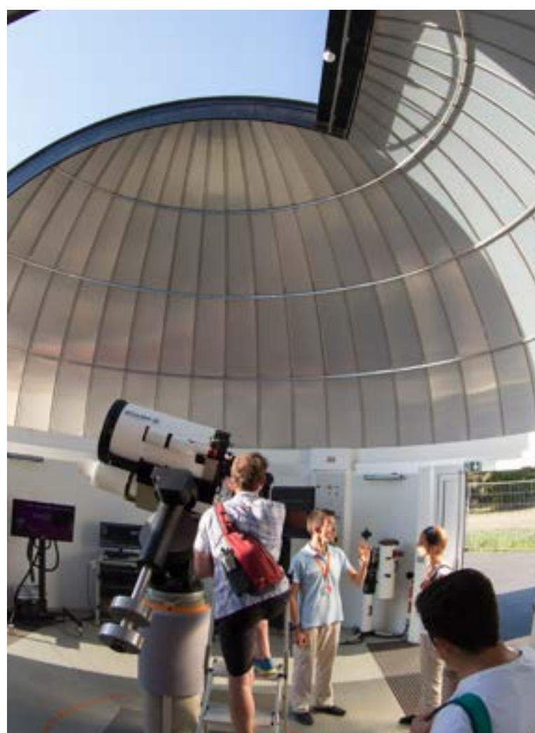
Con un diámetro de 7,5 m, la cúpula alberga un telescopio de 40 cm y un catalejo para observar el Sol.
